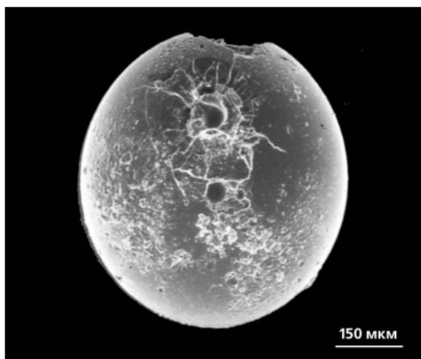
Рис.3. Шарик ударного расплава из грунта, доставленного одним из «Аполлонов» (слева) и микрократер на стеклянном шарике из коллекции «Луны-16». Изображения получены методом сканирующей электронной микроскопии.
