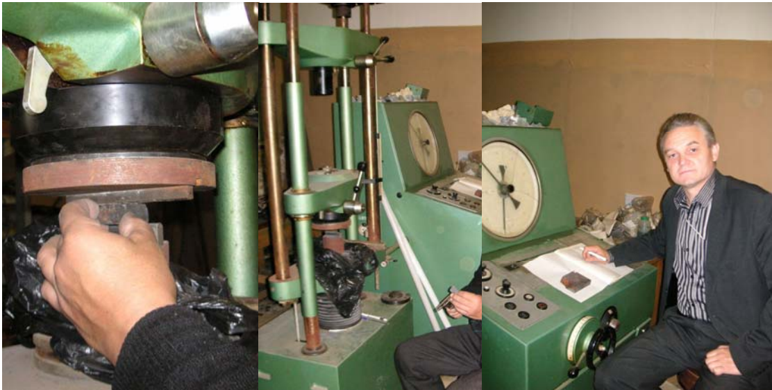
Рис. 4.4.1. Определение предела прочности на сжатие и растяжение образцов метеоритов на испытательных прессах серии CD-10 и CD-100.
