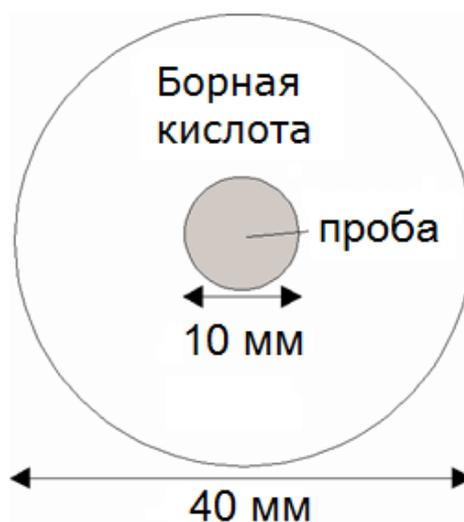
Рисунок 8 – Схема излучателя, приготовленного прессованием на подложке из борной кислоты
