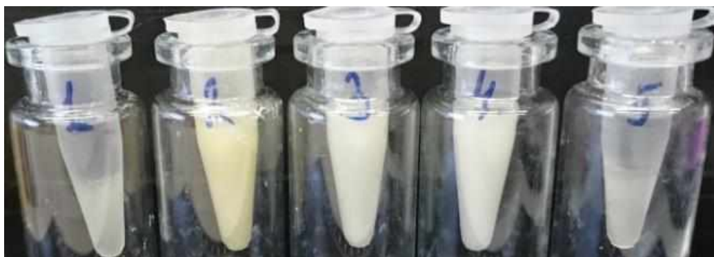
Рисунок 5.2.2-3 – Взаимодействие органической фазы с различными реэкстрагентами: 1 – 1 моль/л \text{H}_3\text{PO}_4 , 2 – 1 моль/л \text{NaHCO}_3 , 3 – 3 моль/л МАК + 1 г/л ДТПА, 4 – 1 моль/л \text{H}_3\text{PO}_4 ( \text{pH} = 10 ), 5 – 1 моль/л АУК ( \text{pH} = 10 )
