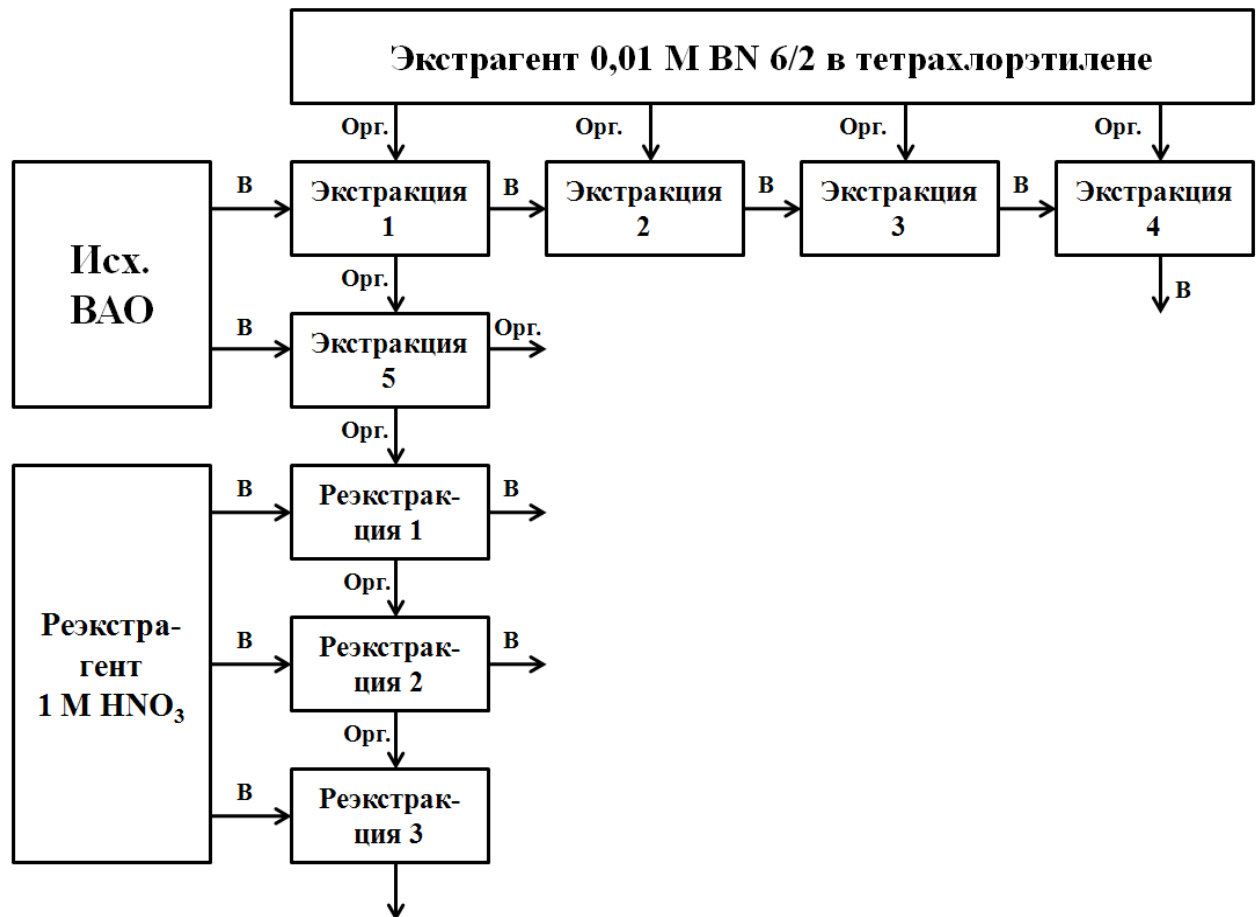
Рисунок 5.2.2-1 - Принципиальная схема статических испытаний с БН 6/2
