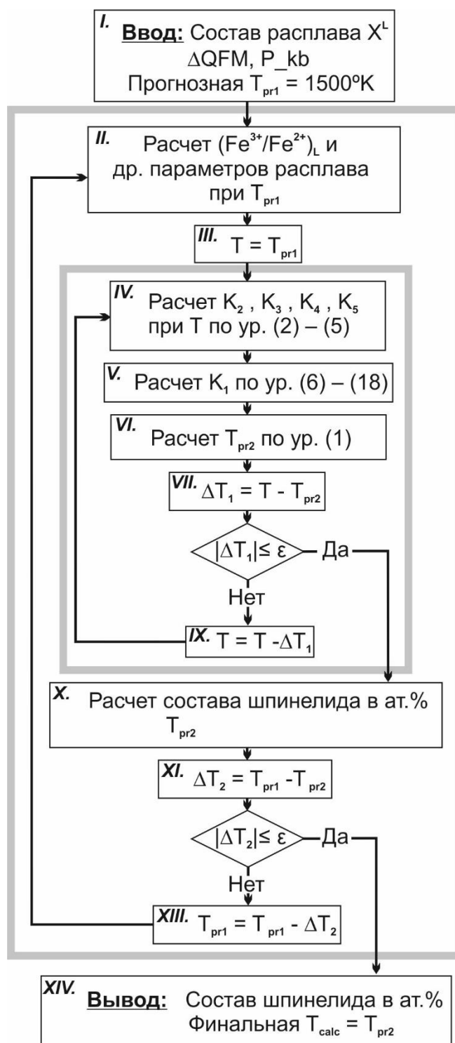
Рис. 2. Принципиальная блок-схема алгоритма расчета равновесия S_r -L модели SPINMELT-2.0.
