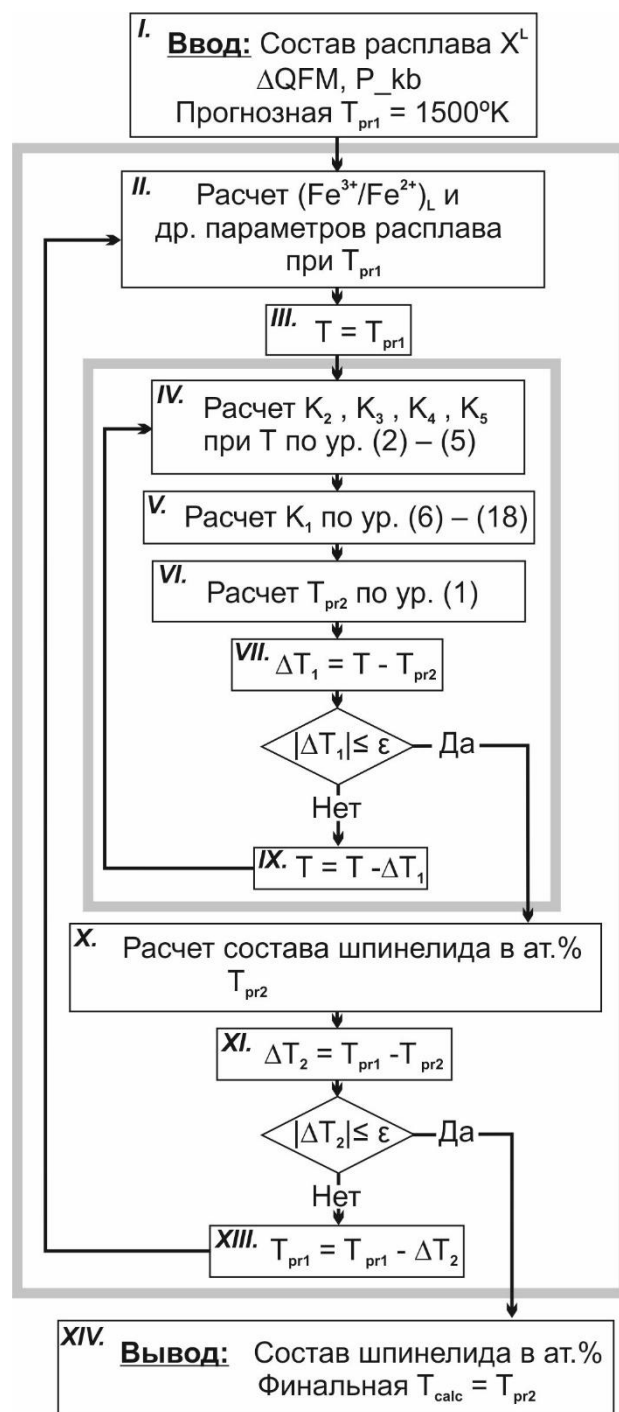
Рис 4-3. Принципиальная блок-схема алгоритма расчета равновесия шпинелид-расплав модели SPINMELT-2.0.
