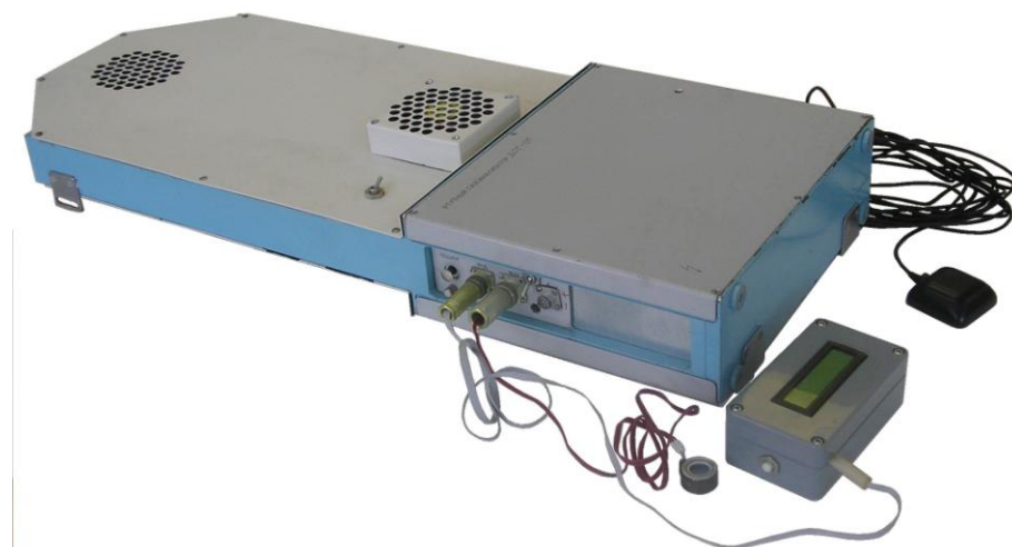
Рис. 1. Внешний вид портативного газоанализатора ртути ДОГ-05 с выносным блоком управления, антенной GPS-приемника и калибровочной кюветой с регулируемой температурой.
