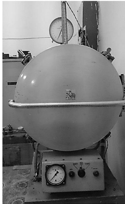
Рис. 3. Вакуумная установка для тестирования газовых сенсоров в газовых смесях и в вакууме.
