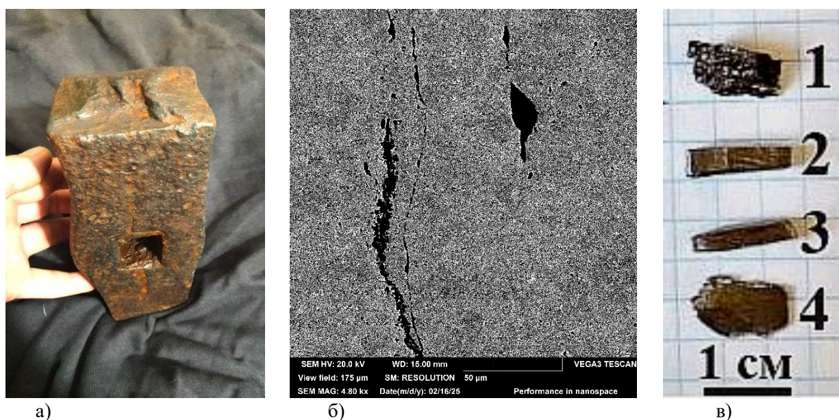
Рис. 1. а) общий вид молота; б) изображение участка чистого железа в СЭМ (режим BSE, высокий контраст); в) форма образцов для анализа.
