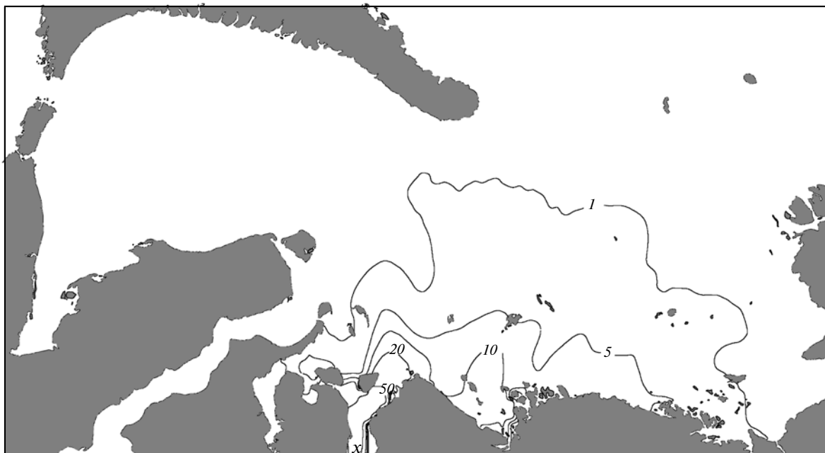
Рис. 3. Поверхностная концентрация Cs^{137} ( Bq/m^3 ) при постоянном сбросе в Енисейском заливе после трех лет модельного времени. Коэффициент p равен 0.1 во всех точках расчетной области.
